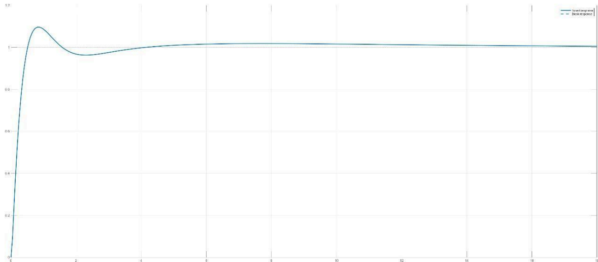
Figura 5.1 La gráfica muestra la respuesta temporal de un sistema controlado por un PID ajustado (Tuned) .
